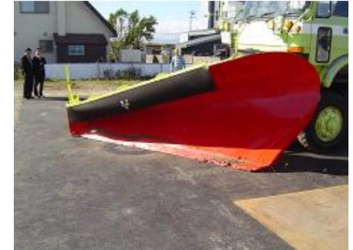
写真-2 横方向衝撃試験
