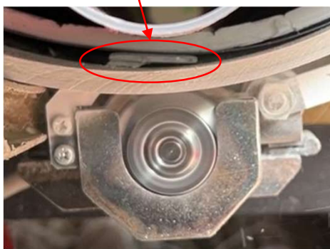
FRP管切断中のケーブル 保護カバー
